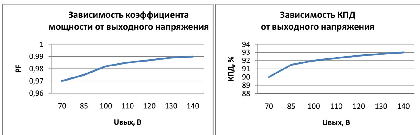
Все параметры измерены при напряжении питания 220В AC и номинальной нагрузке при 25°C окружающей среды.
