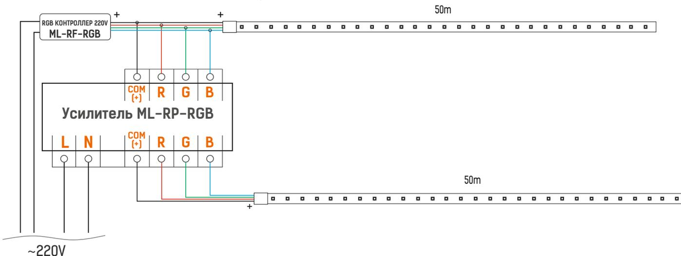
Если после подключения адаптера лента не работает, попробуйте подключить её с другой стороны (поменять полярность). В контроллере, общий плюсовой провод – черный. Рекомендуем использовать гибкий двухсторонний коннектор K-R06 для ленты ML-R60-5050-AC220-RGB-SF.
